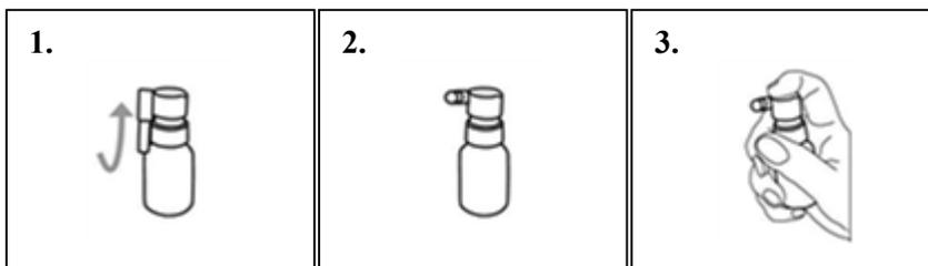
1. Sprühdüse drehen, bis sie waagrecht steht.
